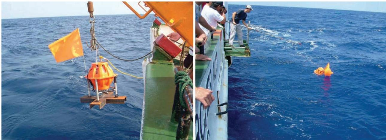
台灣西南海域探測所使用的海底地震儀，是法國製造的 Micro-OBS，外觀體積大小是 60（高）×48（長）×48（寬）公分，重量是 39 公斤（地震儀球體是 19 公斤，固定鐵架是 20 公斤）。左圖是海底地震儀佈放情形，右圖是海底地震儀完成資料蒐集浮出水面後的回收打撈情形。
