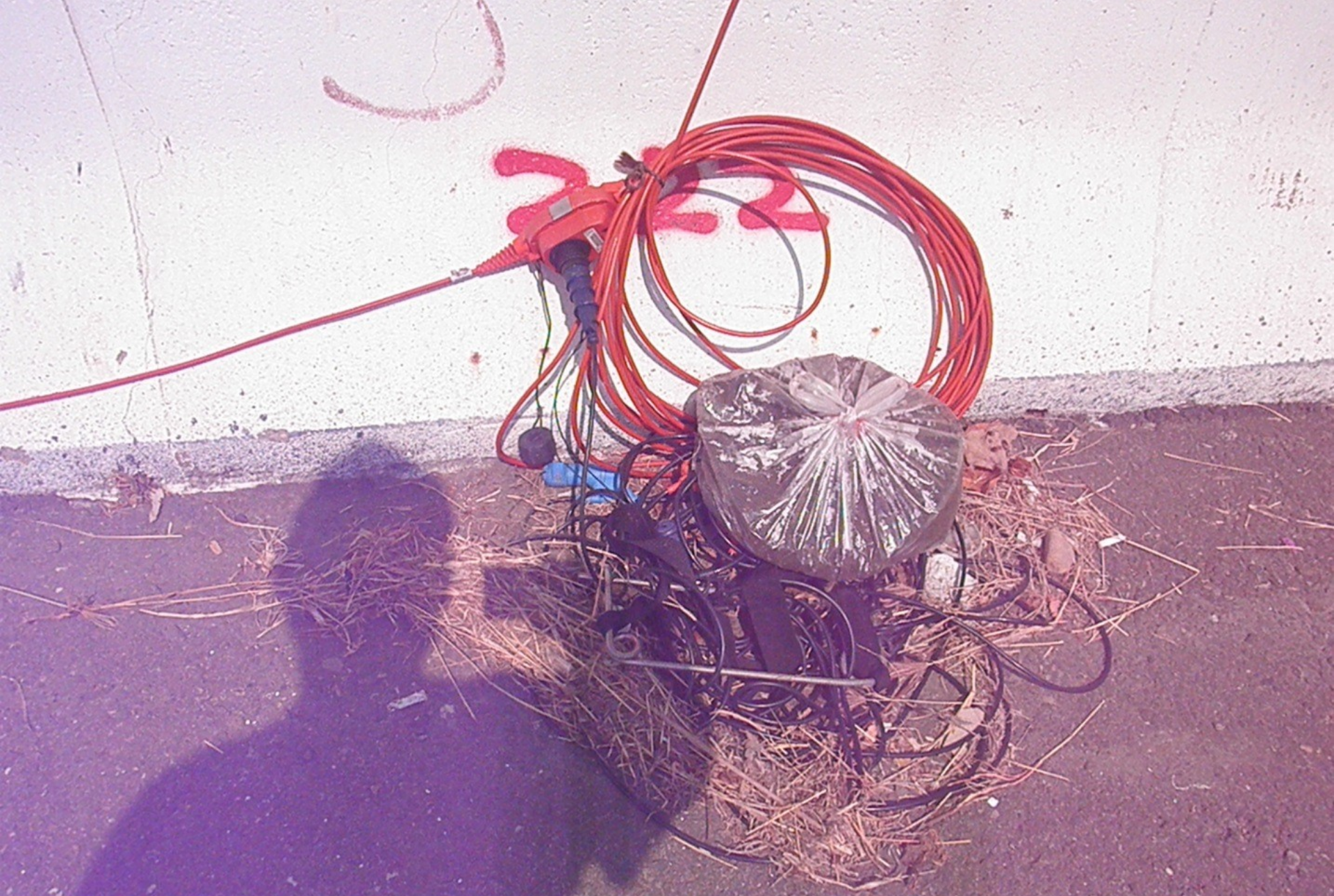
地面受波器 (Geophone) 近照 圖片來源：中油公司內部簡報
